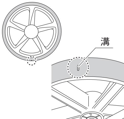
タイヤの接地面には図のような溝が付いています。左右のタイヤの溝どれか一つでも、すり減って確認できなくなつた場合、タイヤの交換時期です。
