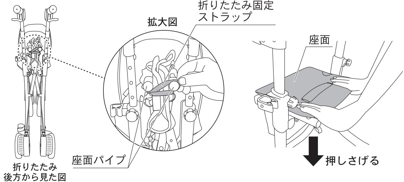
折りたたみ固定ストラップをはずして、車体を軽く左右に広げたあと、座面パイプ後方の両端を上から押しさげてください。
