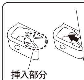
杖立てホルダーへの取り付けは左図の様に、杖立てホルダーの挿入部分から杖を押し入れてください。
