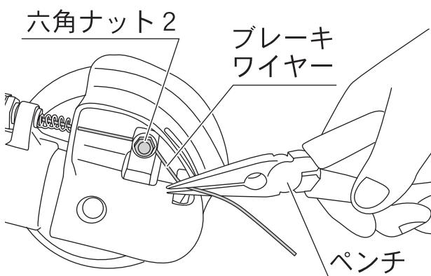
六角ナット2を反時計回りの方向へ回してゆるめ、ブレーキワイヤーをペンチなどで引っぱり、後輪とブレーキパッドのすき間を2mmに調節してください。その後、六角ナット2を時計回りの方向へ回して締めてください。調節後、ブレーキワイヤーの引き具合が左右均等になっていることを確認してください。
