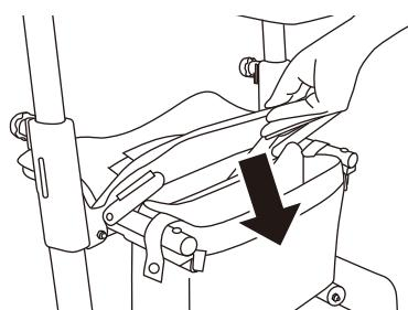
2 袋の固定取手部分を本体の固定フックに取り付けてください。その際、かならず固定フックに完全に固定されていることを確認してください。
